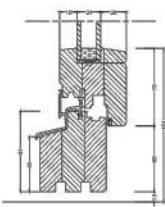
Lăcrimăr de aluminiu aplicat pe traversa inferioară a tocoului
