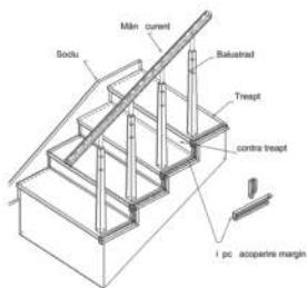
Elementele componente ale unei scări sunt: grinziile de susținere trepte; stâlpii de susținere scară; treapta; contratreapta; palier; balustrada; suport mâna curentă; mâna curentă.
