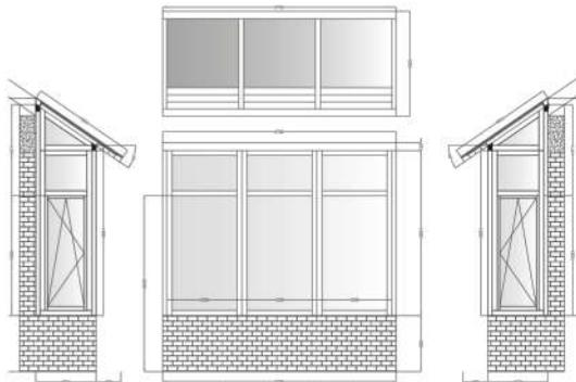
Asemenea ferestrelor și ușilor de intrare, serele sunt confectionate din grinzi stratificate răšinoase, stejar, sau meranti echipate cu geam termopan, conform arhitecturii casei.
